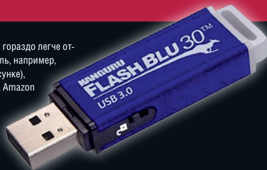
► Kanguru ALK-FB30 имеет переключатель защиты от записи, способный предотвратить перезапись файлов. Пока он пребывает в режиме только для чтения, данные добавлять нельзя.
