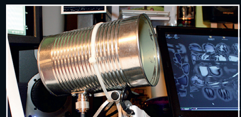
» Консервная банка и провод работают как мощная антенна для USB-брелка Wi-Fi.
